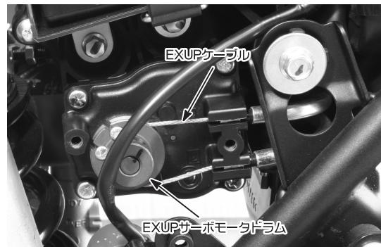
※EXUPサーボモータドラムからEXUPケーブルを取り外した状態。
