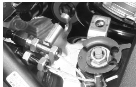
※EXUPドラムからEXUPケーブルを取り外した状態。
