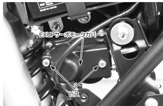
6. EXUPサーボモータドラムからEXUPケーブルを取り外し、EXUPケーブルを車体から取り外す。
