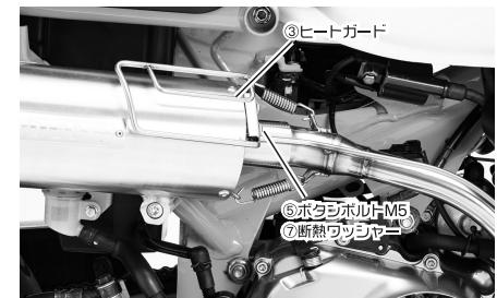
取付後しばらくの期間は初期緩みが発生しやすい傾向にあります。試運転後に必ず点検をし、必要があれば増し締めをします。また、定期的に点検・増し締めを行って下さい。
