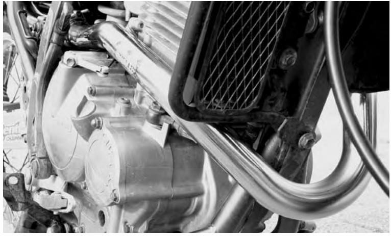
6. マフラーを取り付けます。全て仮締めの状態にして下さい。
